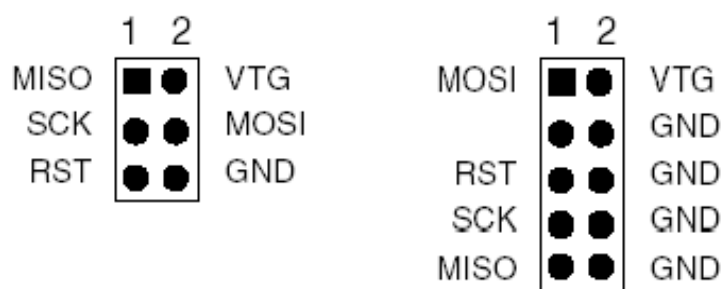
Rysunek 1. Złącze programujące
