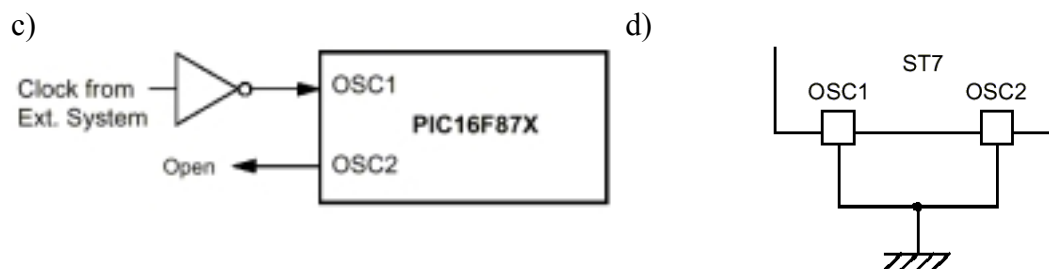
Rys. 2.14. Sposoby generowania sygnału zegarowego
