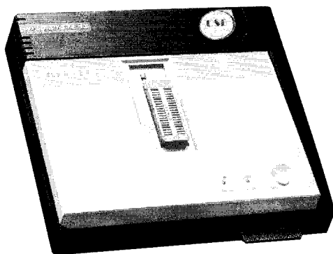
Fot. 9.8. Wygląd uniwersalnego programatora stacjonarnego ALL-11 firmy HiLo Systems
