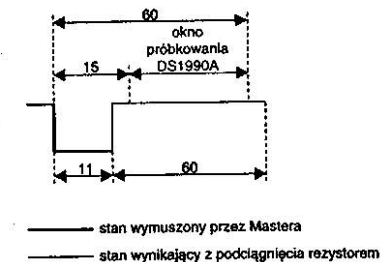
Rys. 14.26. Okno wpisu „1” do rejestru wejściowego układu iButton (czasy w mikrosekundach)
