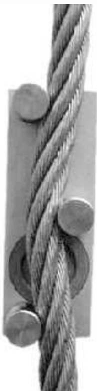
urządzenia pomiaru obciążenia kabiny
